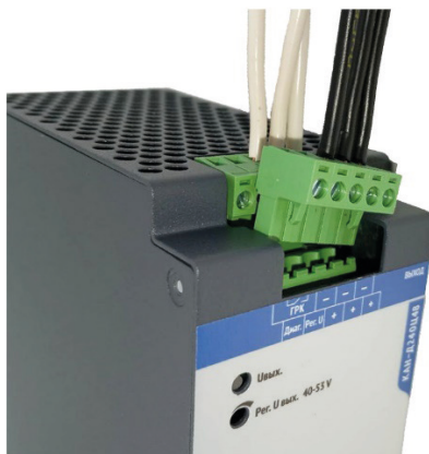
Рисунок 8 – Съёмный разъём на примере КАН-Д240Ц48
